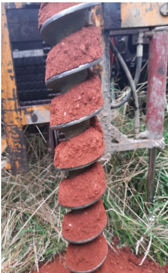
Przykład próby gruntu OW3 4,20 - 5,00 m p.p.t. Rozwiercona skała macierzysta
