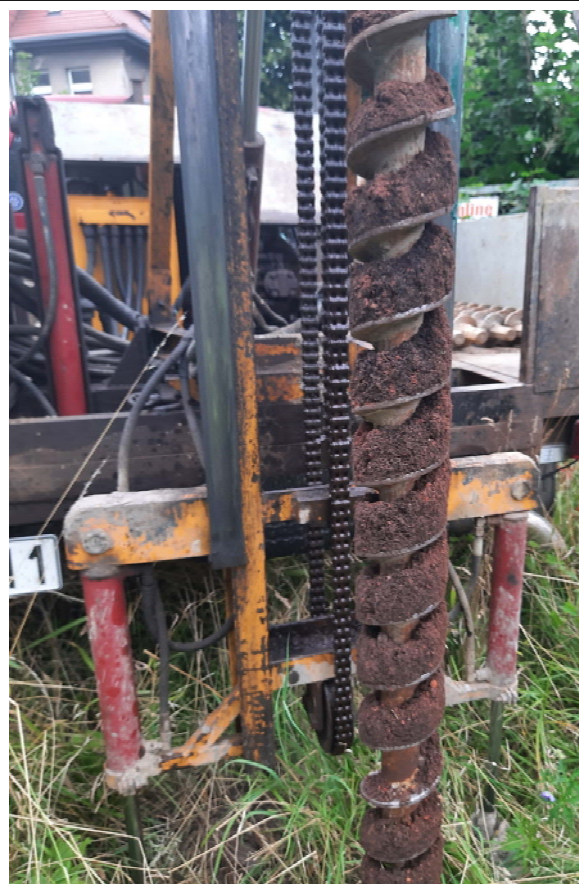
Przykład próby gruntu OW1 0 - 1,50 m p.p.t. Nasyp niekontrolowany
