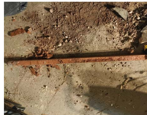
Widok miejsca badań w dniu 30.08.2021 Wiercenia zestawem RKS wewnątrz budynku
