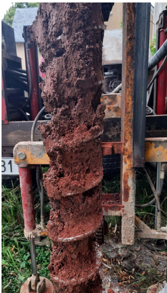
Przykład próby gruntu OW6 1,10 - 2,00 m p.p.t. Pospółka zagliniona
