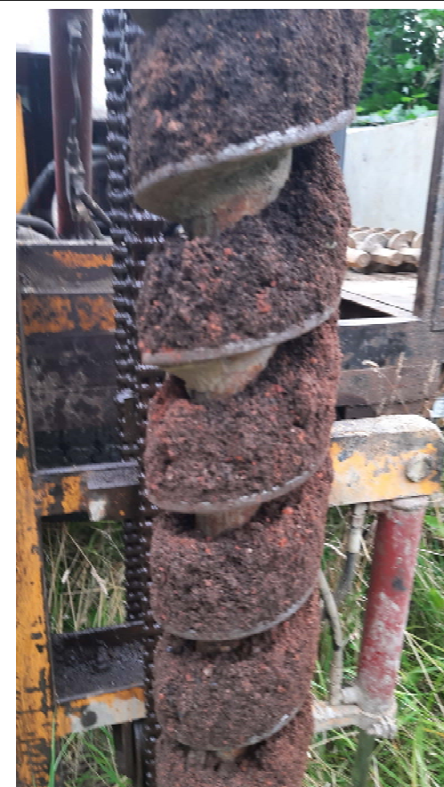
Przykład próby gruntu OW2 0 - 1,50 m p.p.t. Nasyp niekontrolowany
